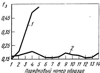
Рис. 85. Изменение коэффициента трения при последовательной прокатке стальных образцов без очистки валков (1) и на чистых валках (2). Условия прокатки: валки стальные незакаленные, шероховатость поверхности 9-го класса; температура прокатки 1050 °С
